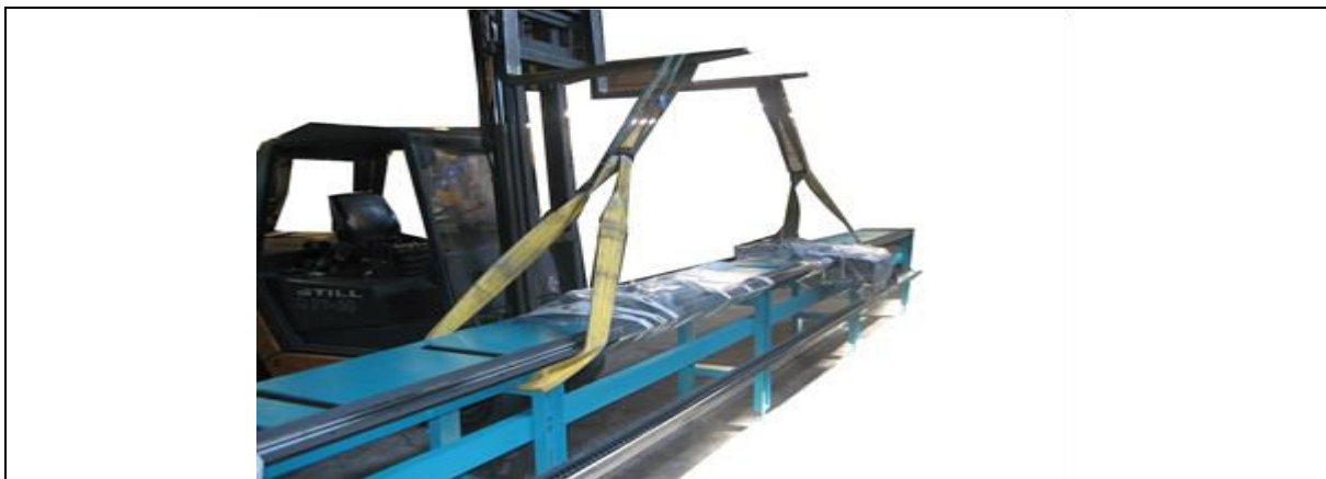
Hijzen van een compleet systeem, incl. rollenbaan
